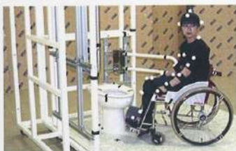
模擬トイレでの移乗計測実験
