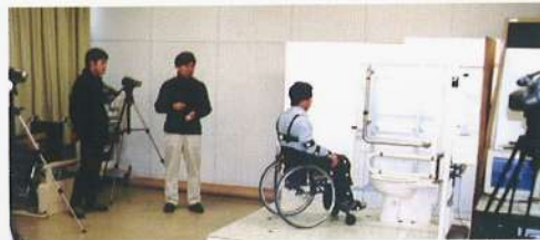
模擬トイレでの移乗計測実験
