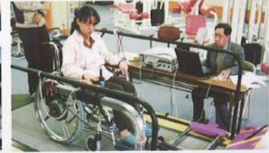
電動車いす消費エネルギー計測実験
