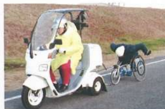
牽引走行実験
