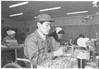
ボイスコイル巻き作業
